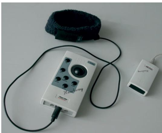
*Головная компьютерная мышь* – это разновидность координатных и манипуляторных устройств, заменяющих компьютерную мышь. Головная мышь обеспечивает точное (вплоть до пикселя) позиционирование курсора благодаря движению головы пользователя. Для этой
