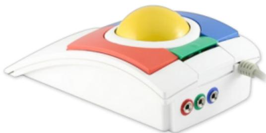
*Трекбол* представляет собой перевернутую мышь, оснащенную подвижным шаром, который, будучи закрепленным на специальной подставке, вращается благодаря указывающему
