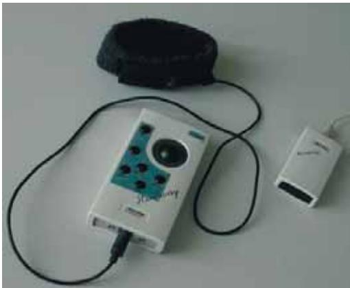
*Головная компьютерная мышь* – это разновидность координатных и манипуляторных устройств, заменяющих компьютерную мышь. Головная мышь обеспечивает точное (вплоть до пикселя) позиционирование курсора благодаря движению головы пользователя. Для этой цели на голове пользователя должна закрепляться точка позиционирования при помощи клейкой основы.
