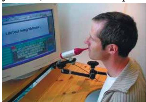
*Электронные указывающие устройства* (например, HeadMouse Extreme) – отличный способ управлять экранным указателем самыми разными способами: ультразвуком и инфракрасными лучами, движениями глаз или сигналами нервных окончаний. Таким обра-
