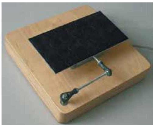
*Ножная компьютерная мышь*. Управление курсором осуществляется нажатием ноги на пластину, поворачивающуюся вверх-вниз, вправо-влево. Размещается на полу, по размеру чуть шире стандартного манипулятора и оснащена всего одной кнопкой.
